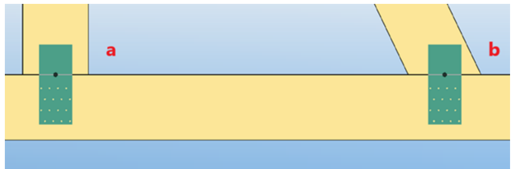
Kuva 2. LL13 Combi naulalevyjen käyttö jatkuvaan paarteeseen yhtyvissä sauvanpäällytöksissä. Sauvanpää voi olla kohtisuoraan (a) tai vinosti (b) sahattu. Combilevyn piikkiosa voi olla kiinni joko sauvanpäässä tai paarteosassa.
